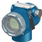
O VTT10-F é um transmissor de temperatura para montagem em campo que possui indicador LCD multifuncional. Aceita sensores T/C, RTD, Ohm e mV, gerando um sinal em corrente 4-20 mA (modelo HART® 7) ou um sinal digital (modelo Profibus-PA), de acordo com sua medição e com a configuração do usuário.
