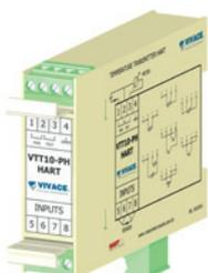
O VTT10-P é um transmissor de temperatura para montagem em trilho DIN que aceita sensores TC, RTD, Ohm e mV, gerando um sinal em corrente 4-20 mA (modelo HART® 7) ou um sinal digital (modelo Profibus-PA), de acordo com sua medição e com a configuração do usuário. No modelo HART®/4-20 mA possui duas saídas discretas open-collector para geração de alarmes, ou sinais liga/desliga.
