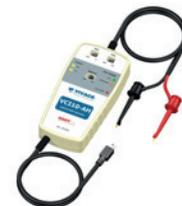
A VCI10-AH é uma interface de comunicação HART® para utilização com dispositivos que possuam a tecnologia Android®.
