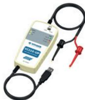
A VCI10-UP é uma interface de comunicação Profibus-PA para utilização com dispositivos que possuam conexão USB tipo-A padrão.
