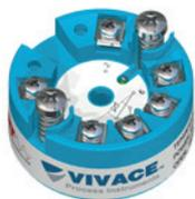
O VTT10-H é um transmissor de temperatura para montagem em cabeçote (head mount - DIN Form B-compliant) que gera um sinal em corrente 4-20 mA (modelo HART® 7) ou um sinal digital (modelo Profibus-PA), de acordo com sua medição e com a configuração do usuário.
