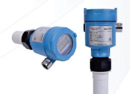
Os medidores ultrassonicos da linha UL 1000 foram produzidos para medição de nível sem contato direto com o produto. A eletrônica incorporada no cabeçote possui um avançado microcontrolador e uma exclusiva tecnologia de processamento de detecção de Eco, garantindo a utilização em diversas aplicações e condições de processo.
